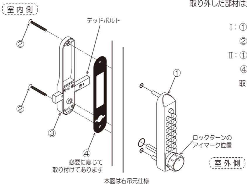
②室内座のテッドボルトが収まっている状態で取り外します。
